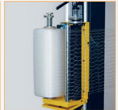
EM - Mechanische Bremse an der Spindelwelle
